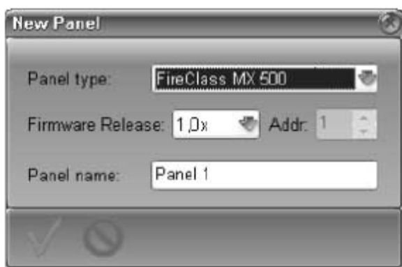
19. ábra. Az új ablak panel (vezérlő panel típus)
